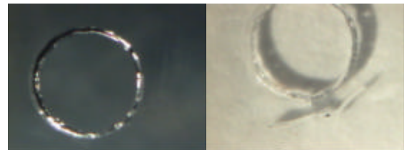
Abb.3: Mikroskopaufnahmen von Schnitten bei Verwendung geeigneter Parameter (links) bzw. Rissbildung bei ungünstigen Parametern (rechts)
