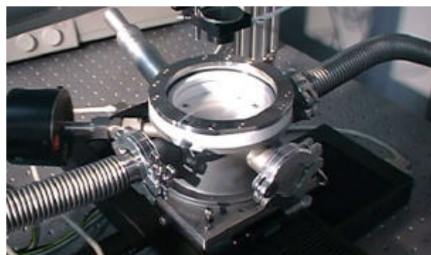
Abb.4.1: CVD- Vakuumkammer zur Bearbeitung von 4“ Wafern
