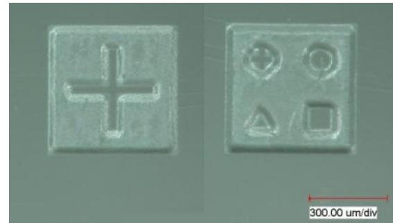
Bild 7. Links: 300 \text{ µm} lange und 30 \text{ µm} hohe Kreuzstruktur, 2 Abtragsschichten. Rechts: Verschiedene 54 \text{ µm} hohe Modellgeometrien auf einer 500 \text{ µm} \times 500 \text{ µm} großen Abtragsfläche, 4 Abtragsschichten.
