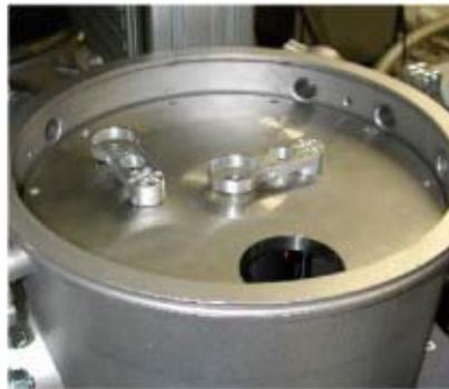
**Abb. 1: Zwei separat geführte kombinierte Ringrakel**
