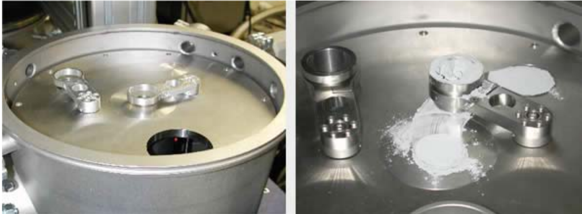
Abb. 1 (links:) Variation der Materialzusammensetzung durch Einsatz mehrerer Rake Abb. 2 (rechts:) Zylinderklingen dienen als Rakel und Zwischenspeicher für Pulver
