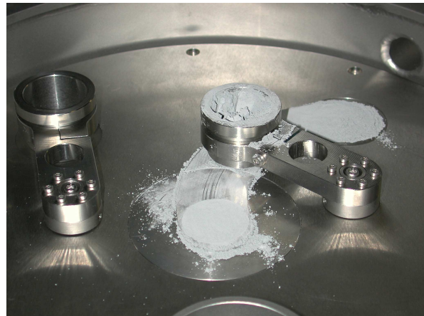
Abb. 2: Zylinderklingen dienen als Rakel und Zwischenspeicher für Pulver
