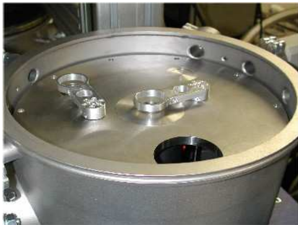
Abb. 1: Variation der Materialzusammensetzung durch Einsatz mehrerer Rakel
