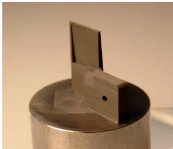
Bauteil mit innenliegendem Kanal und Mikroschlitz aus Wolfram
