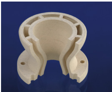
ABBILDUNG 7: Durch die hohe Eigendichte lassen sich mit Zirkonoxid und dem SLM-Verfahren gut konturierte Bauteile herstellen (Quelle: Fraunhofer ILT Aachen).
