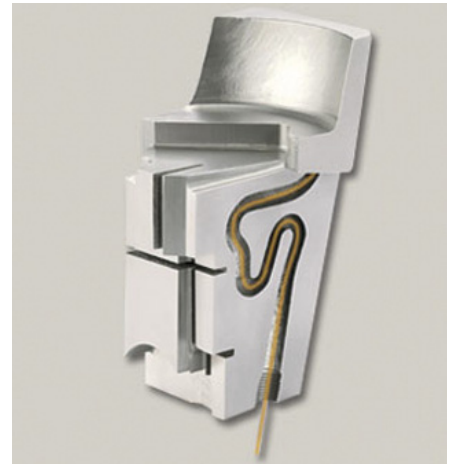
ABBILDUNG 5 Durch das SLM-Verfahren lassen sich schnell und kostengünstig Druck- und Spritzgusswerkzeuge mit konturngepassten Kühlkanälen herstellen. (Quelle: Concept Laser GmbH).
