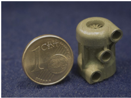
ABBILDUNG 6: Vollintegrierte Mikroturbine aus Edelstahl. Hergestellt via Lasermikrosintern mithilfe gütegeschalteter Laser und kurzen Pulsen (A. Streek; Projekt „Rapid Microtooling mit laserbasierten Verfahren“; Hochschule Mittweida). Dieses Verfahren zeichnet sich durch die Verarbeitbarkeit von allen bekannten Metallen bei besonders hohen Auflösungen aus (bis zu 30 µm).
