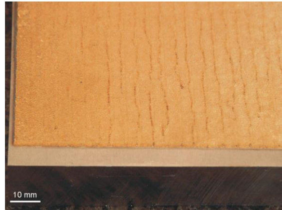
Bild 3: Laserauftragsschweißung einer Bronzelegierung auf einem höherfesten Stahl
