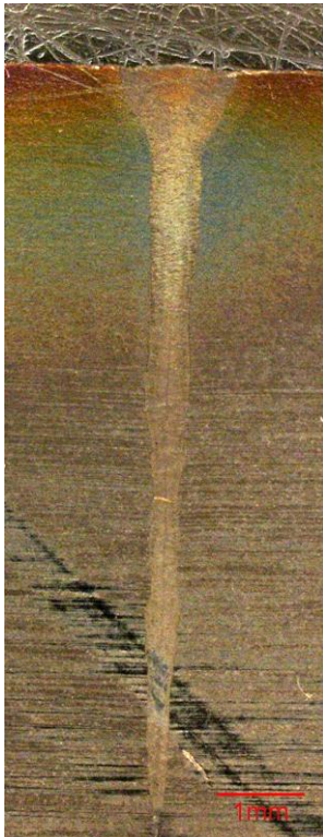
Abb. 3: Stumpfstoßschweißung in Edelstahl 1.4301, P = 3 kW, Monomode, v = 2 m/min, Schweißkopf, f = 500 mm, Einschweißtiefe 8,6 mm
