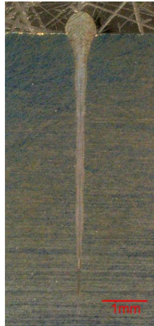
Abb. 4: Blindschweißung in Edelstahl 1.4301, P = 3 kW, Monomode, v = 10 m/min, Schweißkopf, f = 240 mm, Einschweißtiefe 6 mm
