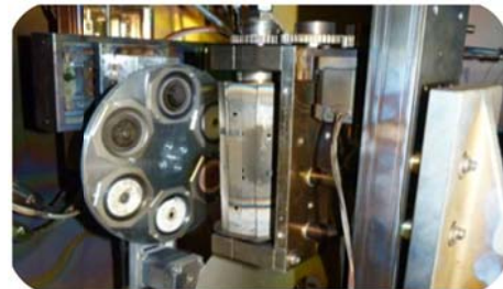
Abb. 1 Beschichtungskammer mit Substratbewegungseinheit und 6-fachem Targetwechsler.
