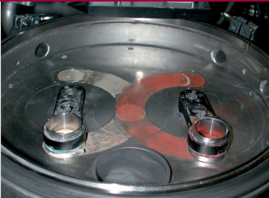
Bild 2. Kammer mit zwei Ringrakeln: Glatte und dichte Schichten mit einer Auflösung von 0,5 µm sind möglich
