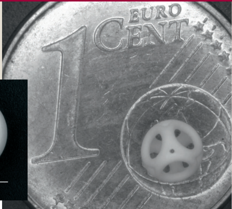
Bild 5. Hochaufgelöste Teile aus \text{Al}_2\text{O}_3 -Keramik: Komplexe Hinterschnidungen sind einfach zu realisieren
