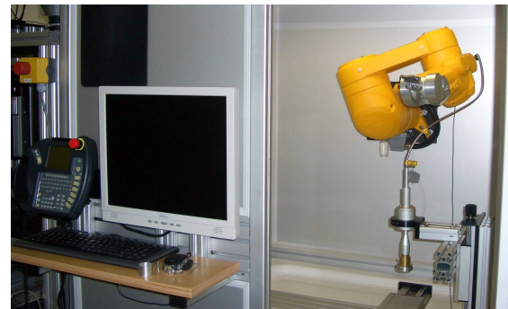
Abb. 6: Anlage zum Mikropulverauftragschweißen
